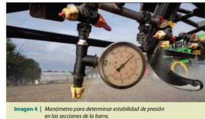
Imagen 4 | Manómetro para determinar estabilidad de presión en las secciones de la barra.
